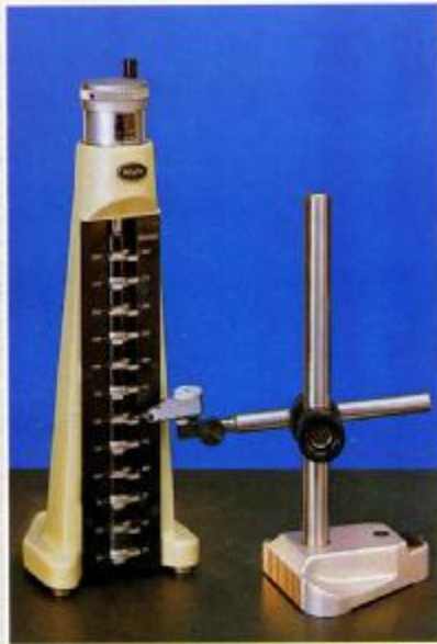
HEIGHT MASTER دقت اندازه گیری 2µm
