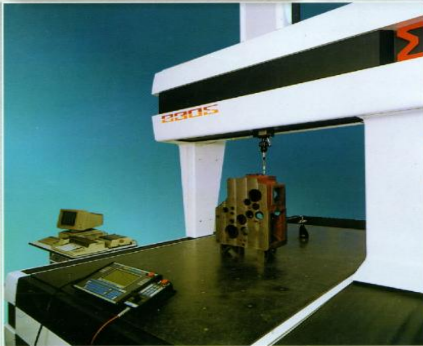
CMM M / C SIGMA 2305 دقت اندازه گیری: 0.5 \mu\text{m}
