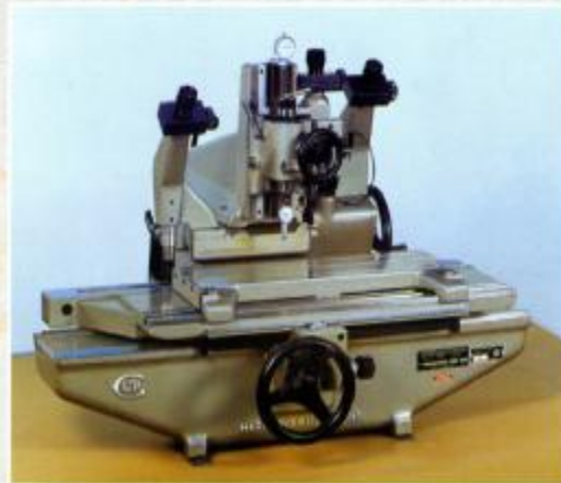
دقت اندازه گیری : 0.5 \mu\text{m} - MU 214 B
