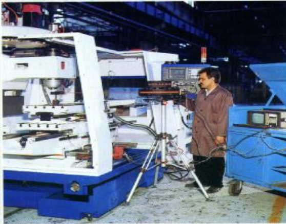
اندازه گیر لیزری LASER ZLI 150 دقت اندازه گیری 0.1 \mu\text{m}
